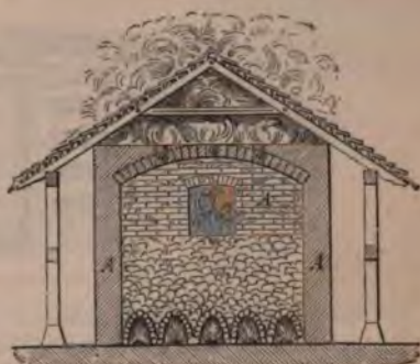
Fig. 218. — Four à plâtre ordinaire.
